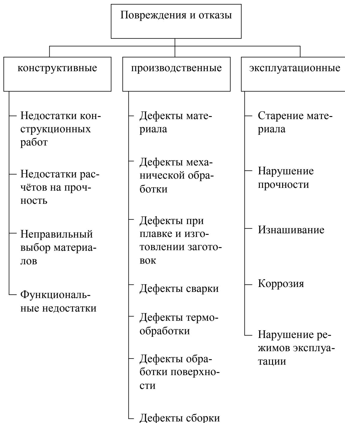
Рис. 1.2. Виды повреждений и отказов
